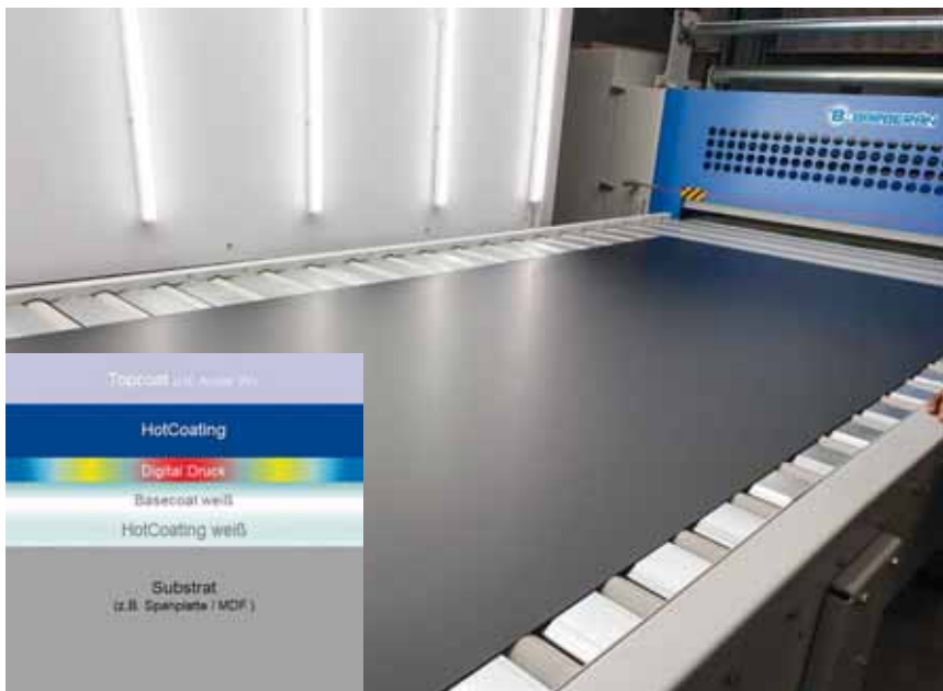
„Hot Coating“-Schichtaufbau für Digitaldruckplatten
