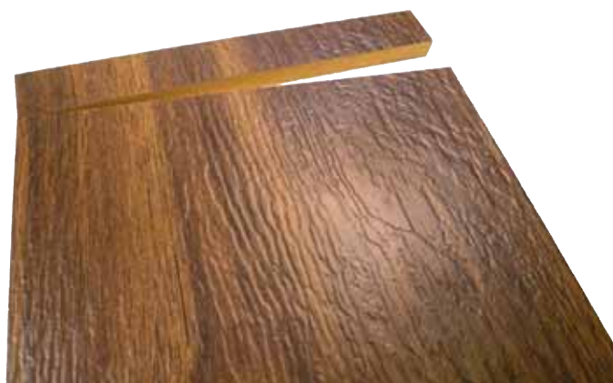
Musterplatte mit Holzstruktur-artig geprägter „Hot Coating“-Oberfläche
