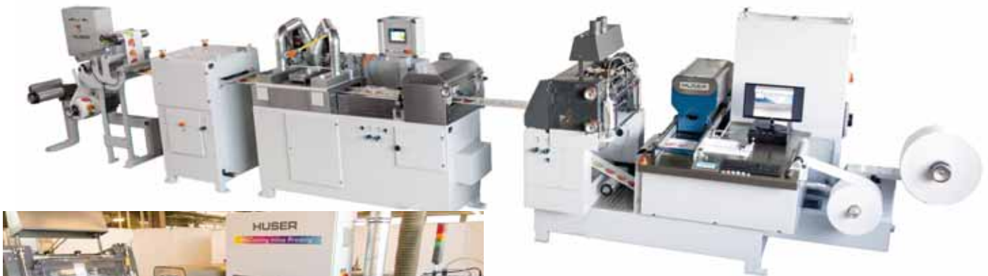
„Hot Coating“-Digitaldrucklinie von Maschinenpartner Huser
