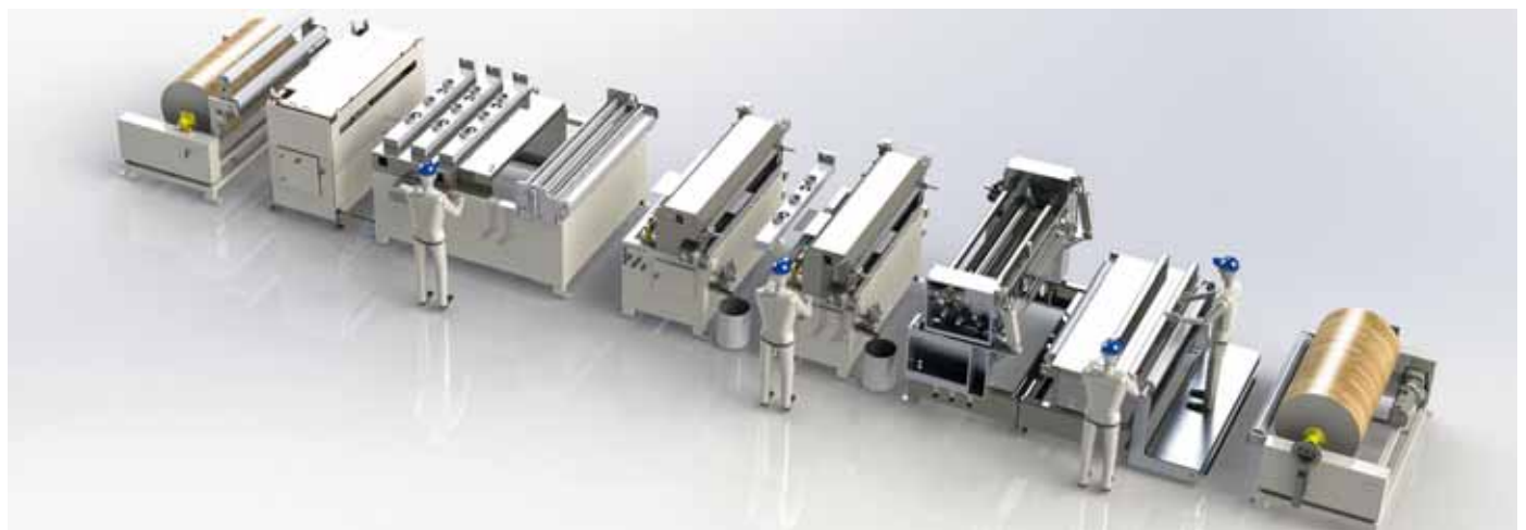
„Hot Coating“-Linie mit einer Anlagenbreite von 1 600 mm für bedruckte Papiere und thermoplastische Folien
