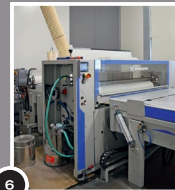
6 Reinraum: Auftrag „Top Coat“. Mit der gleichen Maschine kann nun entweder die „soft matt“-Oberfläche oder die „high gloss“-Oberfläche erreicht werden.
