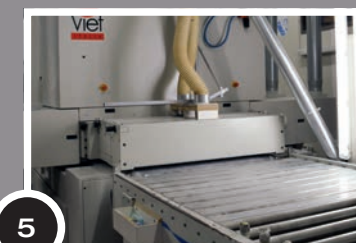
5 Anschleifen in der Schleifmaschine. Regelmäßige Prüfung des Glanzgrades zur Kontrolle des Schlichs. Absaugen und Abbürsten des Schleifstaubs – Übergang in den Reinraum.
