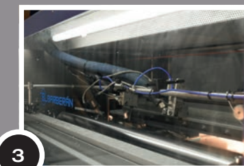
3 Veredelung der Oberfläche mit „HotCoating“ als Performance-Schicht.
