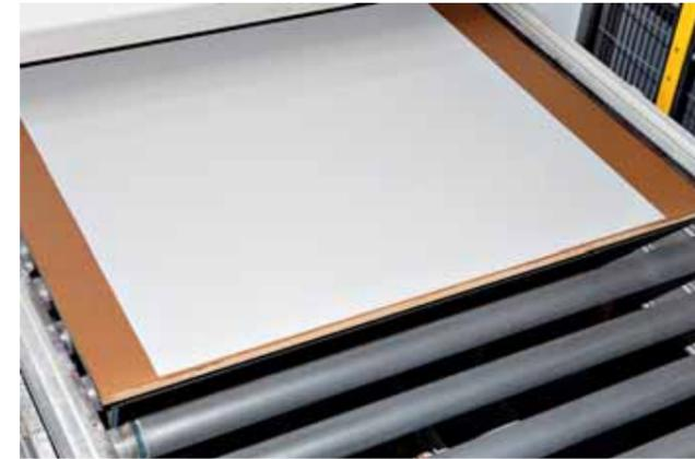
**Die 2,8 mm starken Polyurethan-Platten werden für den Produktionsprozess auf eine Trägerplatte temporär aufgebracht (links)**
